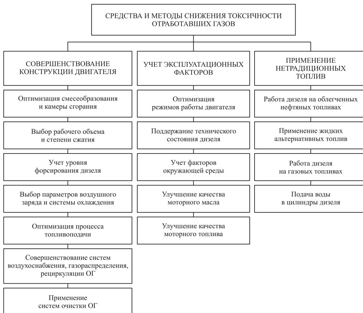
Рис. 3. Схема основных средств и методов снижения токсичности ОГ дизелей
