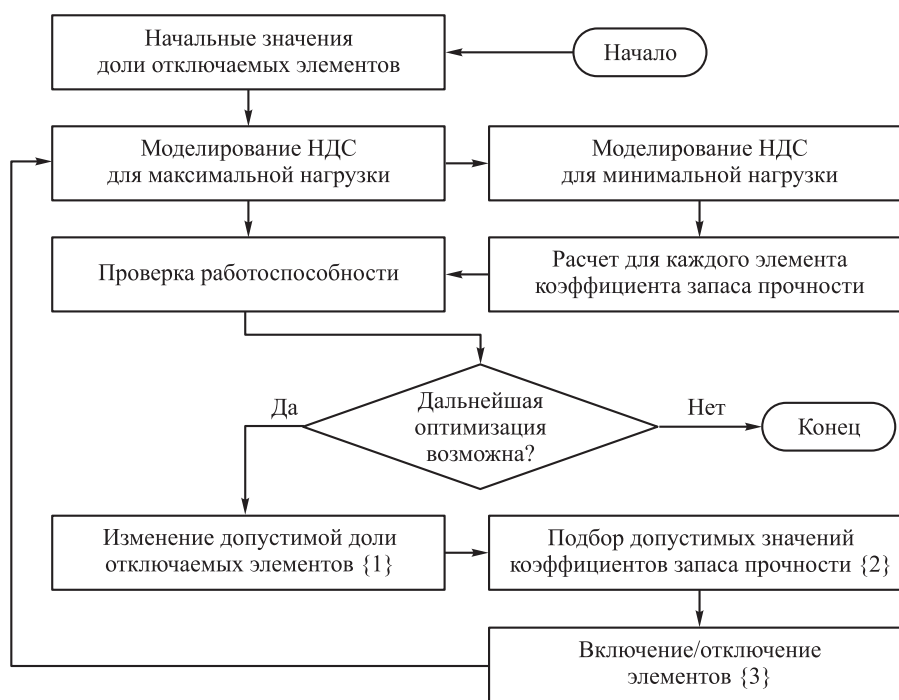
Рис. 1. Общая блок-схема алгоритма поиска оптимальной формы детали
