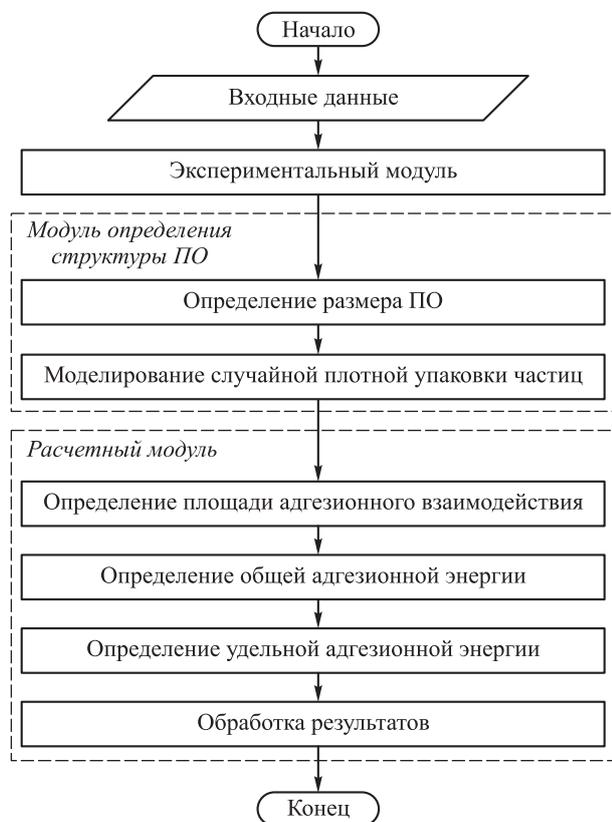
Рис. 3. Блок-схема алгоритма расчета удельных энергетических характеристик ДУПКМ
