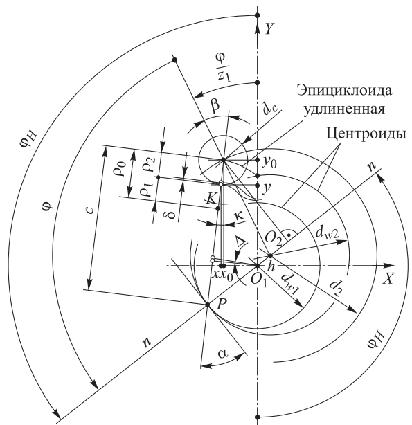
Рис. 2. Схема внецентроидного циклоидального зацепления
