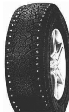
Рис. 2. Расположение шипов в крайних зонах беговой дорожки шины
