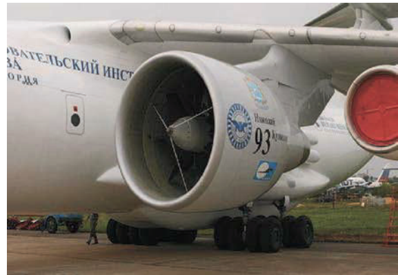
Рис. 4. Двигатель НК-93, установленный на летающей лаборатории Ил-76ЛЛ
