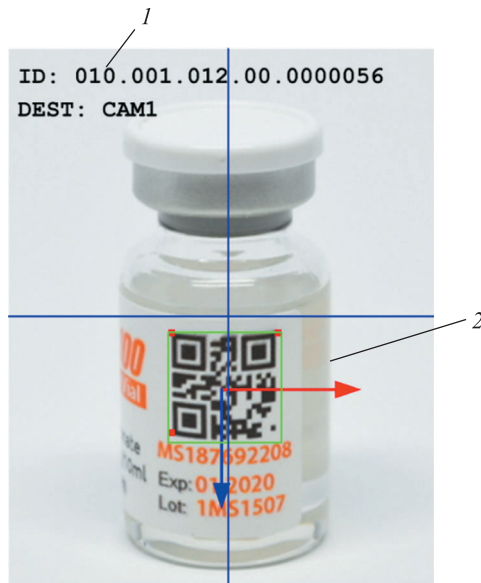
Рис. 12. Лабораторная тара в поле зрения СТЗ РТК с выводом сопровождающей информации:
