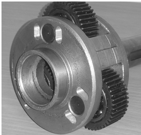
Рис. 5. Внешний вид опытного образца блока сателлитов ПП с податливым водилом
