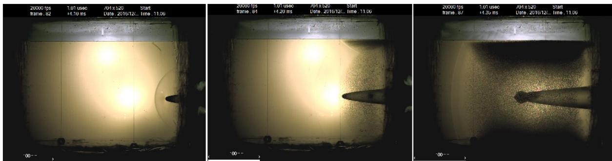
Рис. 8. Картины сверхзвукового входа стального кубика в воду (а), движения сегмента поддона в следе (б), удара по кубiku сегментом поддона в каверне (в)
