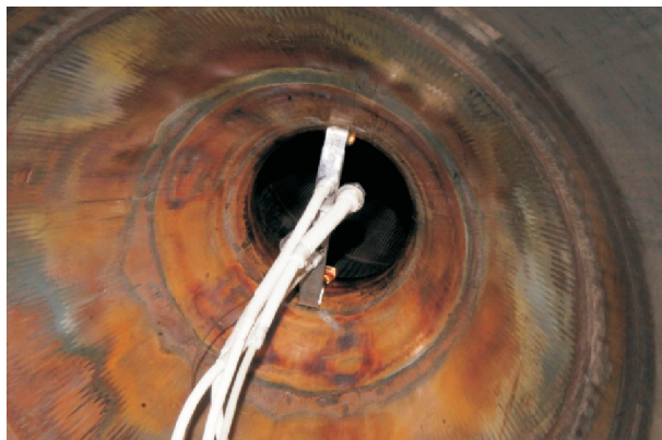
Рис. 7. Закрепление фотодатчиков на камерной установке
