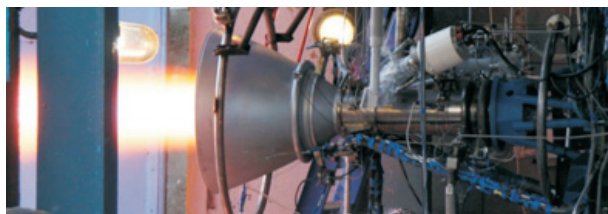
Рис. 10. Фотографии камерной установки в режимах ее запуска (а) и стационарной работы (б) во втором огневом испытании
