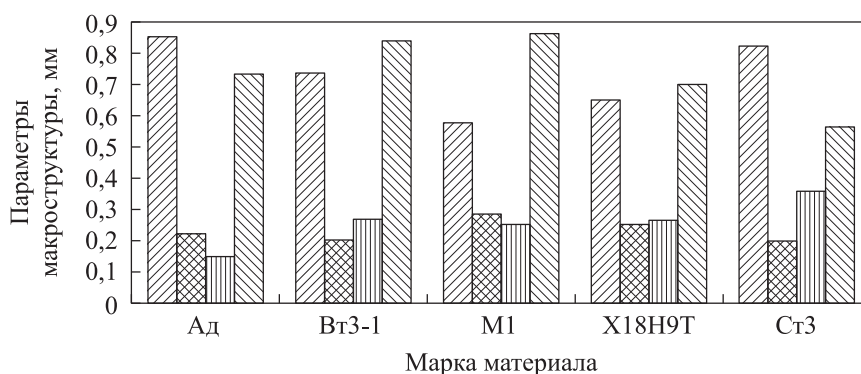
Рис. 3. Параметры макроструктуры титанового КПП, сформированного на поверхности различных материалов, при угле напыления 90°:
