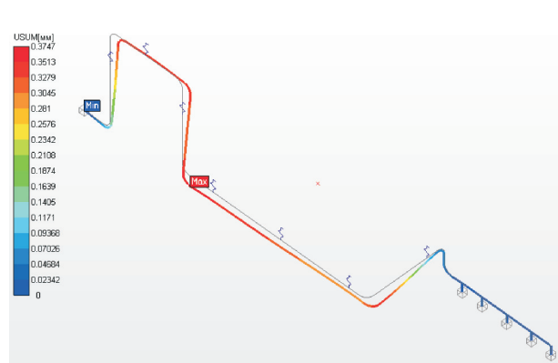
Рис. 6. Карты эквивалентных напряжений (а, б) и суммарных перемещений (в, г) в трубопроводе, возникающих под действием собственного веса, полученные в разных ПК: а, в — APM StructFEM; б, г — ANSYS
