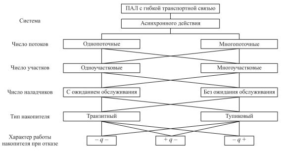
Классификация ПАЛ по математическим моделям для определения их производительности: -q — накопитель не принимает и не выдает заготовки; +q — накопитель принимает, но не выдает заготовки; -q + — накопитель не принимает, но выдает заготовки
