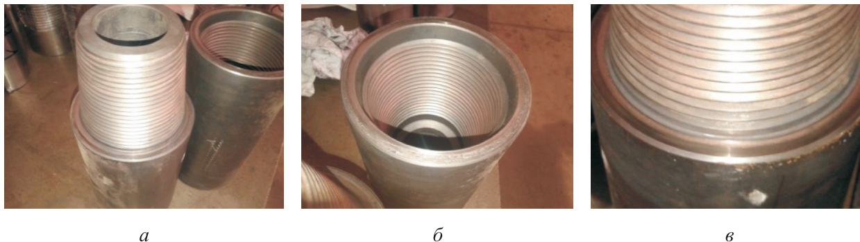
Рис. 6. Результаты износных испытаний образцов с замковой резьбой 3-117, после дополнительного объемного упрочнения переводников карбонитрацией:
