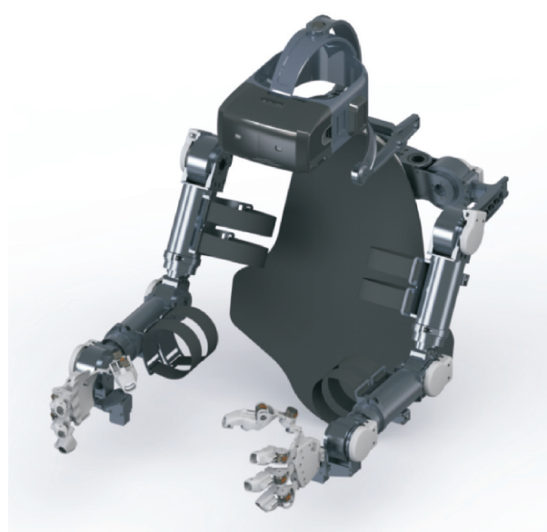
Рис. 4. Пример задающего экзоскелета двустороннего действия (с силомоментной обратной связью)
