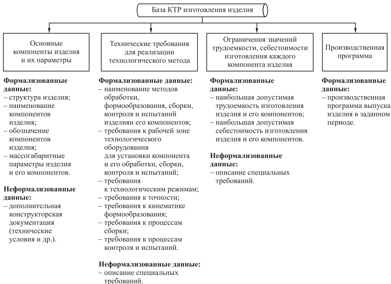
Рис. 4. Семантическая модель КТР изготовления изделия
