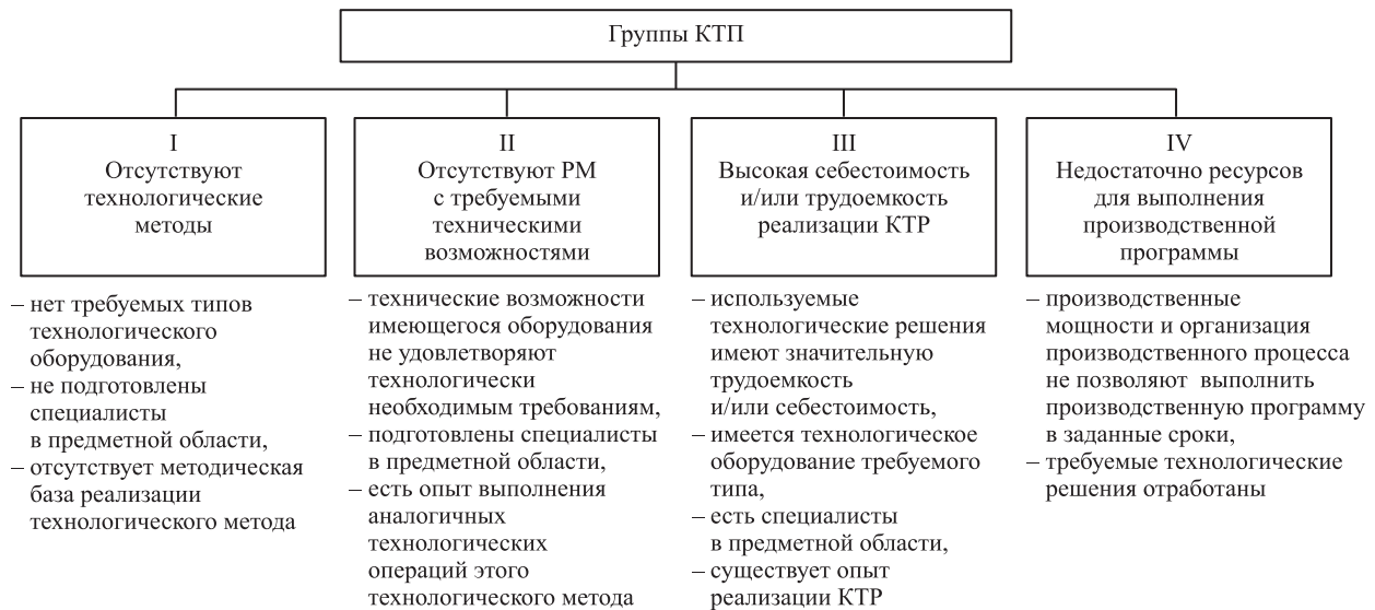
Рис. 1. Группы КТП при оценке производственной технологичности изделий на различных предприятиях-изготовителях
