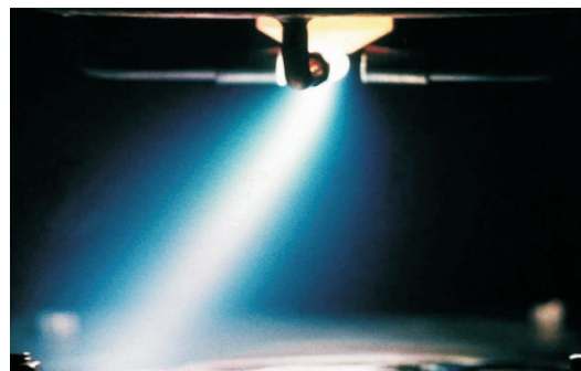
Рис. 2. Внешний вид ДРПК под воздействием поперечного магнитного поля при подаче аргона через полость катода G = 0,5 мг/с, длине дугового промежутка l = 80 мм, силе тока I = 75 А и напряжении разряда U = 22 В
