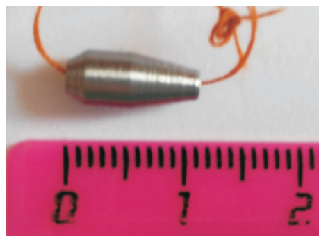
Рис. 6. Внешний вид промежуточной втулки с внутренним диаметром 1 мм
