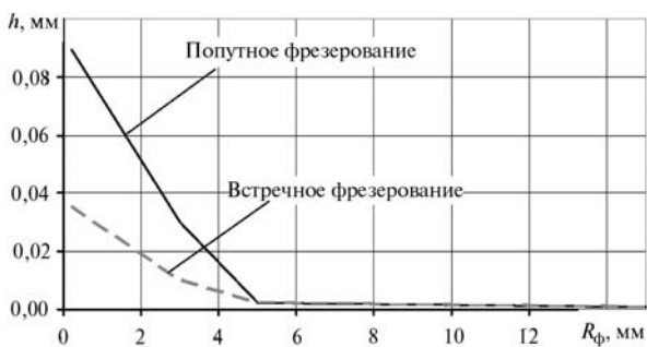
Рис. 2. Зависимость высоты остаточного сечения h от радиуса фрезы R_\phi при попутном и встречном фрезеровании плоскости: S_z = 0,3 мм/об
