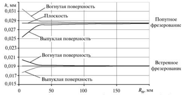
Рис. 8. Зависимость высоты остаточного сечения h от радиуса кривизны обрабатываемой поверхности R_n при попутном и встречном фрезеровании вогнутых и выпуклых поверхностей, а также плоскости: R_\phi = 0,5 мм; S_z = 0,3 мм/зуб
