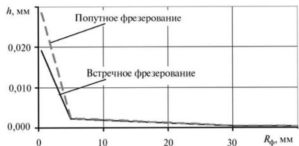
Рис. 6. Зависимость высоты остаточного сечения h от радиуса фрезы R_\phi при попутном и встречном фрезеровании вогнутой поверхности: S_z = 0,3 мм/об; R_n = 100 мм
