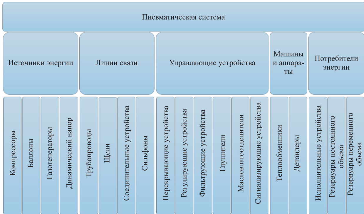
Рис. 9. Классификация агрегатов пневматических систем для разработки шаблонов глобальных расчетных схем типовых агрегатов
