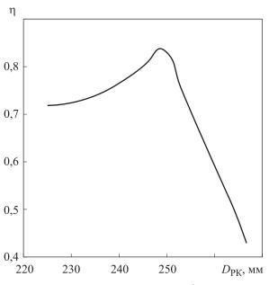
$\it Puc.~4$ . Зависимость КПД турбины  $\eta$  от диаметра РК  $\it D_{PK}$
