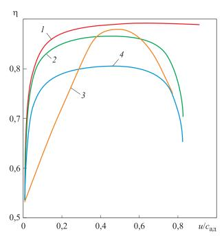
Рис. 8. Зависимости КПД  $\eta$  импульсной ЦСТ с оптимизированными геометрическими параметрами от отношения скоростей  $u/c_{\text{ад}}$ , полученные при расчете:
