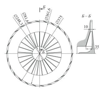
Рис. 7. Конструктивная схема импульсной ЦСТ с оптимизированными геометрическими параметрами
