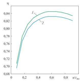
$Puc. \ 3. \$ Зависимости КПД турбины  $\eta$  с аэродинамическим 1 и плоским 2 профилями РК от отношения скоростей  $u/c_{\rm ag}$
