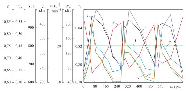
$Puc. \ 9. \ 3$ ависимости параметров оптимизированной импульсной ЦСТ от угла поворота  $\phi$  коленчатого вала поршневого двигателя при их совместной работе:
