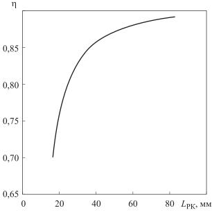
$\it Puc.~6$ . Зависимость КПД турбины  $\eta$  от длины лопаток РК  $\it L_{PK}$
