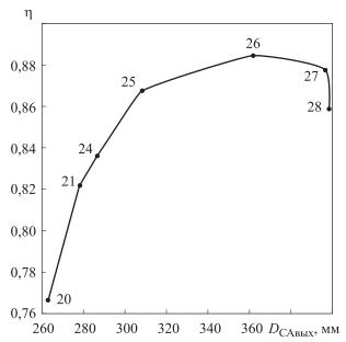
Рис. 5. Зависимость КПД турбины  $\eta$  от диаметра на выходе из СА  $D_{\text{САвых}}$  при оптимальном количестве лопаток (цифрами на графике указано оптимальное количество лопаток)
