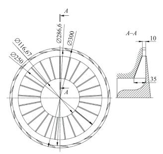
Puc. 1. Схема импульсной ЦСТ с начальными геометрическими параметрами
