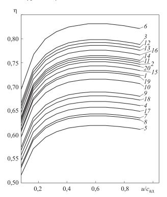
Рис. 2. Зависимости КПД турбины  $\eta$  от отношения скоростей  $u/c_{\rm ag}$  для различных профилей СА (номера кривых соответствуют номерам профилей, указанным в табл. 1)
