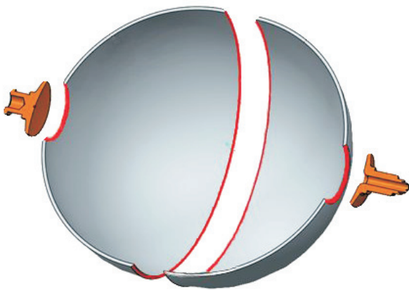
Рис. 1. Типовая конструкция титанового ШБ
