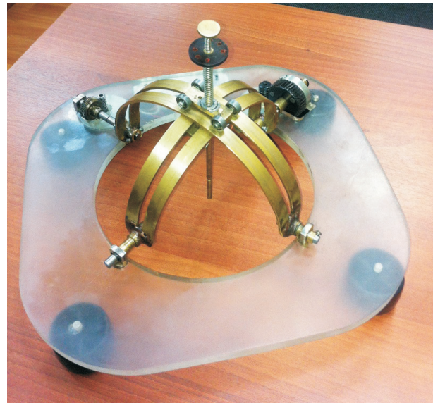
Рис. 2. Внешний вид прототипа МПС с дугообразными направляющими
