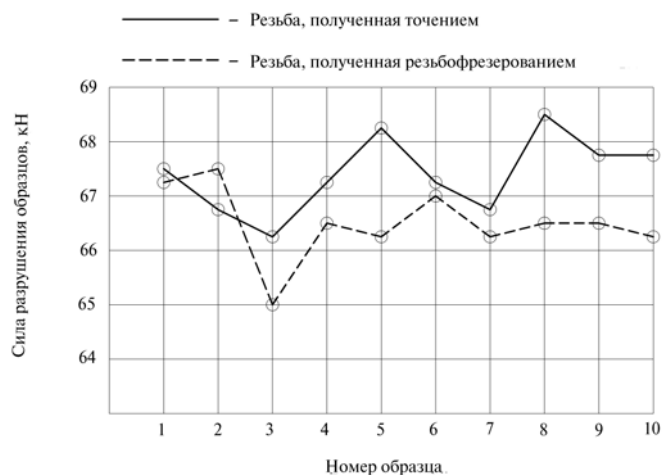
Рис. 10. Сила разрушения образцов при статических испытаниях на растяжение
