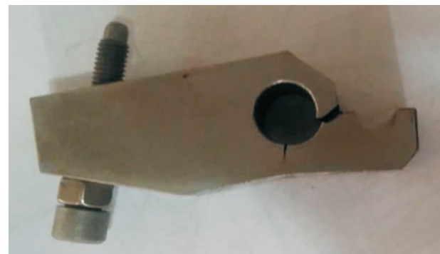
Рис. 4. Внешний вид исходного (а) и разрушенного (б) РСХ
