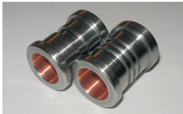
Рис. 6. Внешний вид вкладышей подшипников с переменной жесткостью в центре
