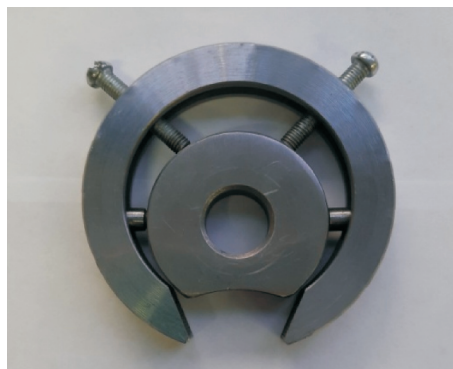
Рис. 8. Внешний вид оснастки для проведения испытаний по схеме ролик — колодка
