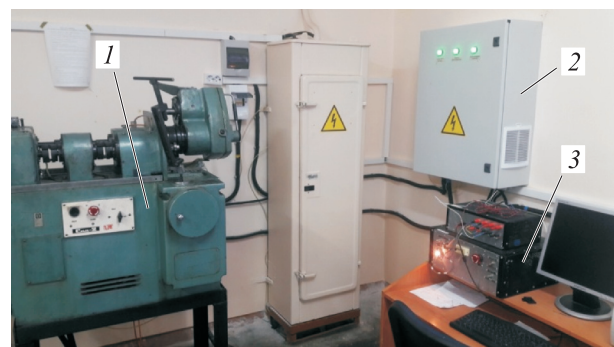
Рис. 6. Внешний вид лабораторной установки: 1 — машина трения СМЦ-2; 2 — шкаф коммутации; 3 — блок обработки и преобразования информации (программируемый логический контроллер)
