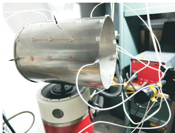
Рис. 1. Внешний вид вибростенда GW-V55/PA300E с закрепленной на его монтажной плите ЦОШ
