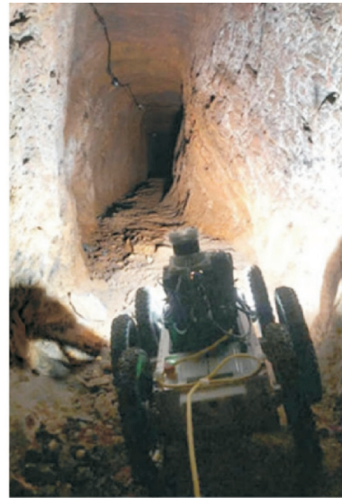
Рис. 3. Схема (а) робота EspeleoRobo и фрагмент осмотра подземного золотого рудника с его помощью (б): 1 — двигатели (6 шт.); 2 — радиоканал; 3 — светодиодная подсветка; 4 и 10 — задняя и передняя видеокамеры; 5 — инерционный модуль MTi-G-710; 6 — лидар Ouster OS1; 7 — интеллектуальная камера T265; 8 — Web-камера D435i; 9 — Mini PC Intel NUC; 11 — аккумуляторы высокой емкости
