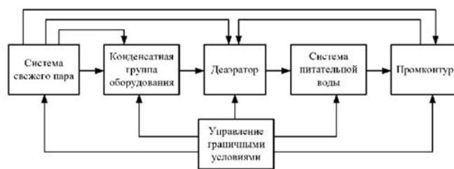
Рис. 8. Функциональная схема ПТУ (упрощенный вариант)
