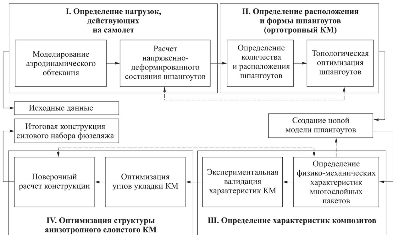
Рис. 2. Схема реализации методики проектирования КСС композитного силового набора хвостовой части самолета
