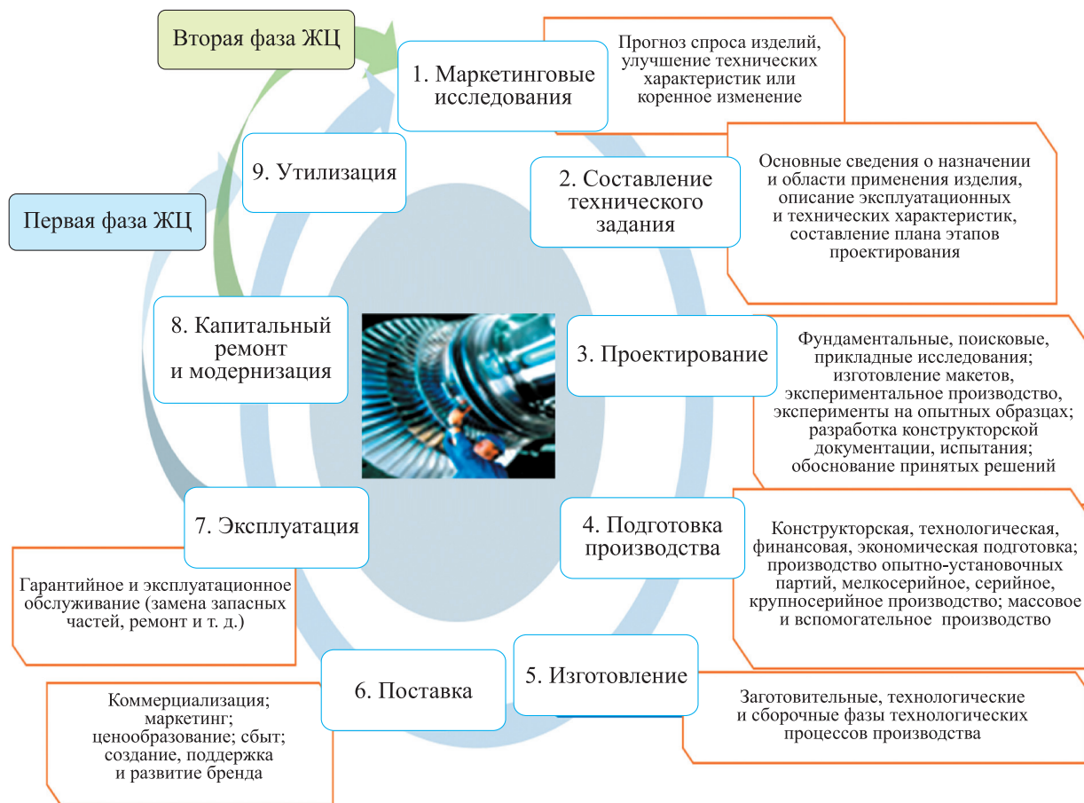
Рис. 1. Схема ЖЦ машиностроительной продукции (изделия) с описанием основных процессов некоторых стадий
