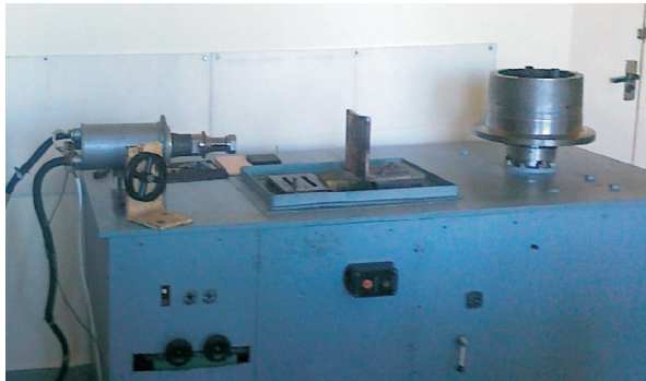
Рис. 2. Внешний вид экспериментального волоочильного стана с ультразвуковым генератором УЗГ 2-4 и магнитострикционным преобразователем ПМС 15А-18
