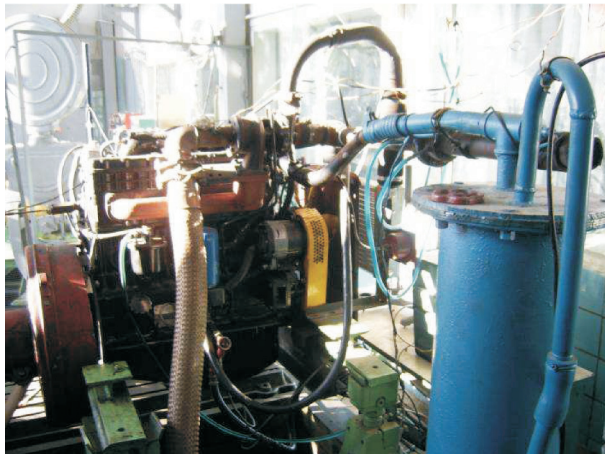
Рис. 1. Внешний вид экспериментальной установки для стендовых исследований дизеля трактора Беларус МТЗ-952
