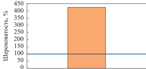
Рис. 4. Значения шероховатости поверхности лопаток после упрочнения LSPwC (■) и по требованиям КД (—)
