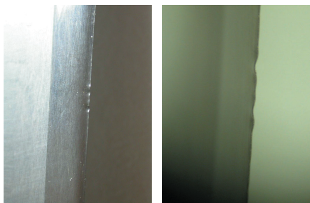
Рис. 7. Внешний вид упрочненной выходной кромки лопатки с утонением (а) и волнистостью (б)
