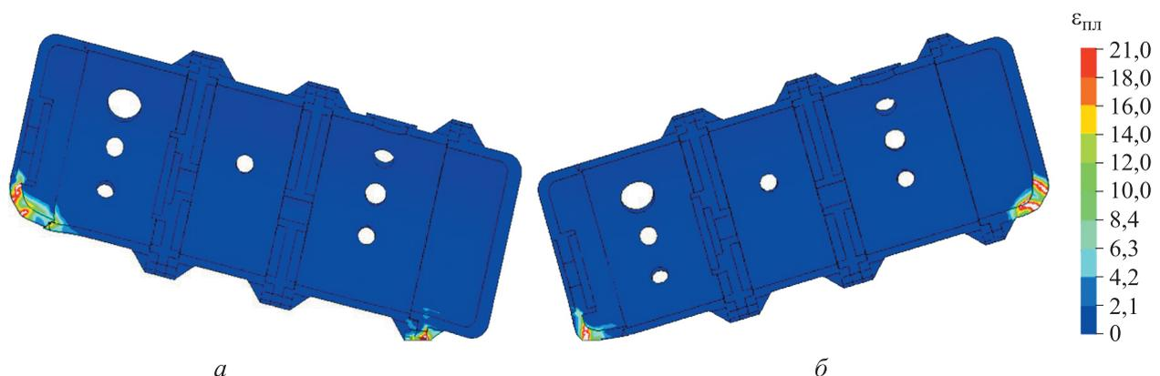
Рис. 4. Распределение пластической деформации  $\varepsilon_{\text{пл}}$ , %, в корпусе ОГК при автономном падении с высоты  $h = 9$  м под углом  $45^\circ$  на днище (а) и крышку (б) после второго удара
