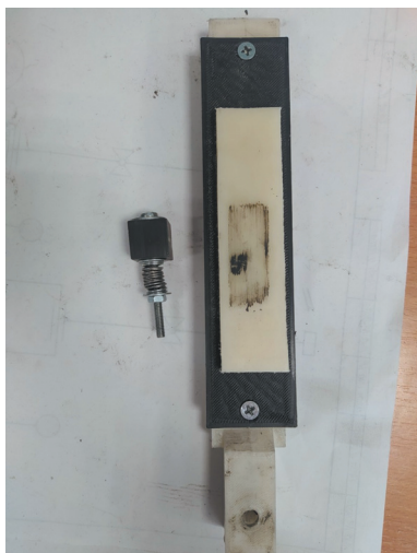
Рис. 4. Внешний вид пары трения после процесса притирки
