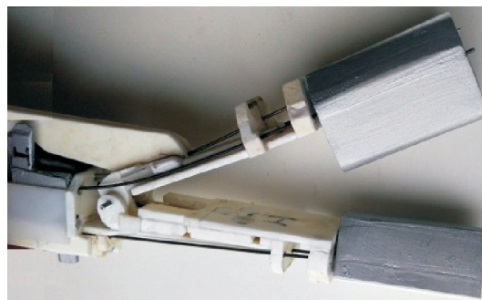
Рис. 4. Внешний вид накладок, расположенных на двух губках
