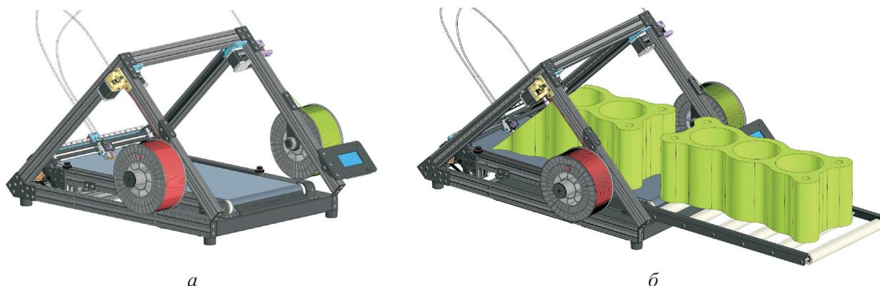
Рис. 1. Цифровой прототип конвейерного принтера при наличии (а) и отсутствии (б) роликовой поддержки
