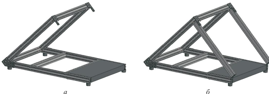
Рис. 4. Цифровой прототип несущей рамы с порталом принтера при отсутствии (а) и наличии (б) дополнительных алюминиевых профилей
