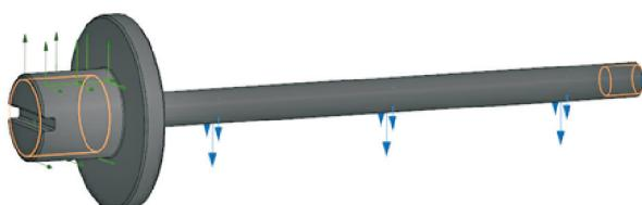
Рис. 10. Цифровой двойник изделия с условиями закрепления и приложения нагрузки
