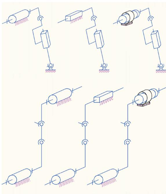
Рис. 3. Схемы МПС с одной степенью свободы и приводными КЦ разного вида
