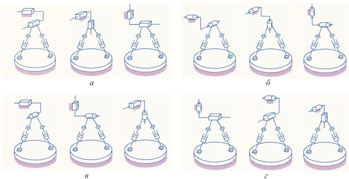
Рис. 4. Схемы синтезированных МПС с двумя степенями свободы, совершающих различные движения:
