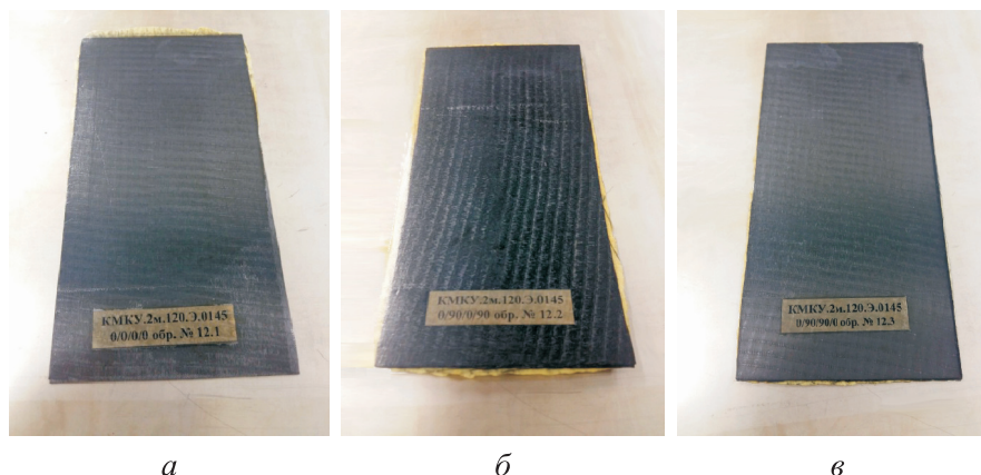
Рис. 2. Внешний вид четырехслойных образцов КМКУ.2м.120.Э01.45 с разными схемами укладки: а — 0/0/0/0; б — 0/90/0/90; в — 0/90/90/0
