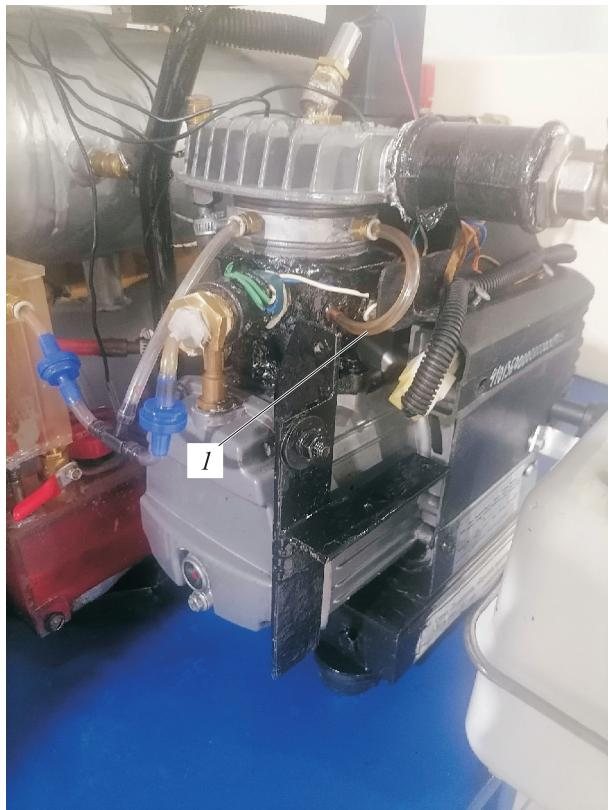
*Рис. 5. Фрагмент экспериментального стенда с организацией подачи газа из рабочей полости в полость всасывания (1 — газовый канал)*
