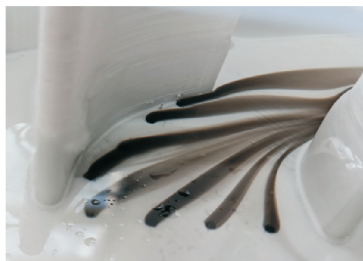
Рис. 5. Картина течения потока в области торцевой поверхности соплового аппарата газовой турбины
