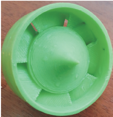
Рис. 6. Внешний вид лопаточного завихрителя потока
