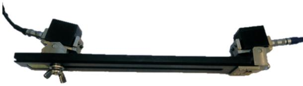
Рис. 3. Внешний вид блока излучатель — приемник УВ
