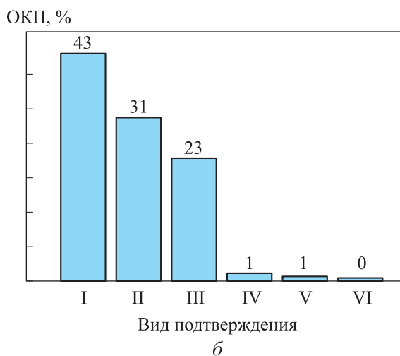
Рис. 1. Результаты исследования попадания посторонних предметов в проточную часть ГТД: а — внешний вид забоин; б — распределение ОКП по видам повреждений (I — забоина на входной кромке; II — отгиб кромки; III и IV — отгиб и обрыв уголка; V — вмятина с разрывом; VI — трещина)
