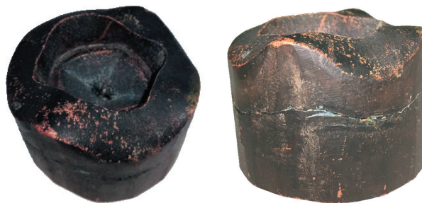
Рис. 3. Внешний вид разрушения концевой части прутка вследствие разрыва скоростей деформации его материала при прокатке
