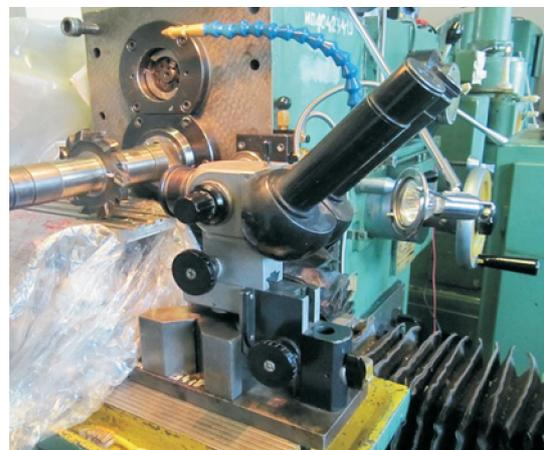
Рис. 3. Фрагмент измерения фаски износа с помощью микроскопа МБС-1
