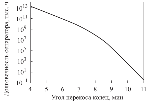
Рис. 5. Зависимость долговечности МС шарикового ПК от угла перекося колец
